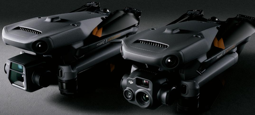
O DJI Mavic 3 Enterprise redefine os padrões da indústria em se tratando de drones comerciais de pequeno porte. Contando com obturador mecânico, câmera com zoom de 56x e um módulo RTK com precisão em nível de centímetros, o DJI Mavic 3E traz a eficiência para missões como nenhum outro drone. Uma versão térmica também está disponível para combate a incêndios, busca e resgate, inspeções e operações noturnas.
